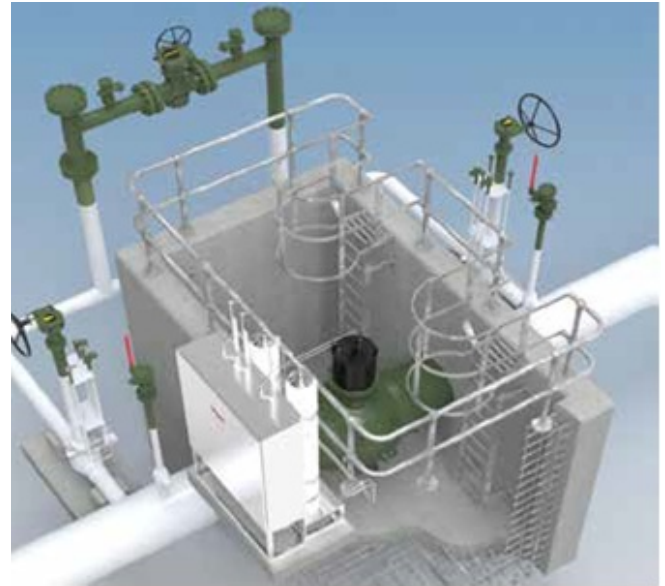
Рис. 8. Перила без закрытого доступа [16]
