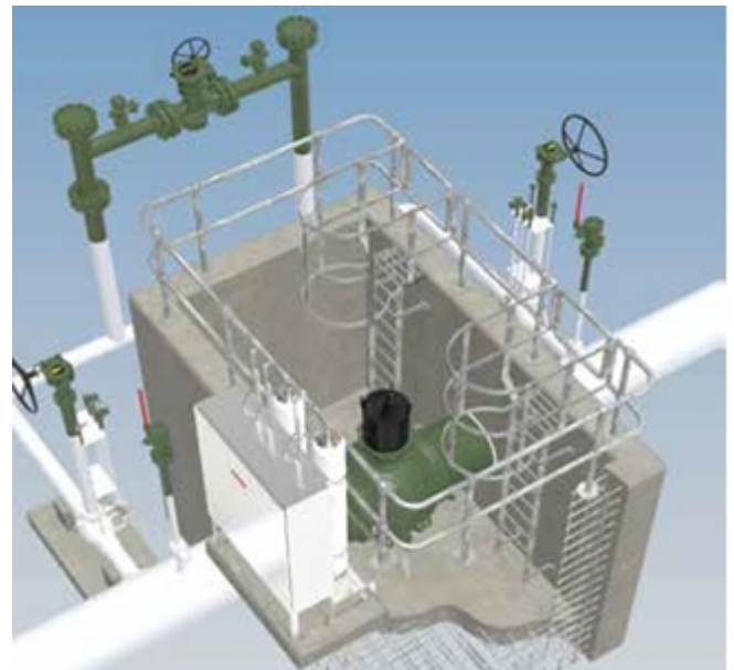
Рис. 9. Перила с закрытым доступом после проверки безопасности на модели BIM [16]
